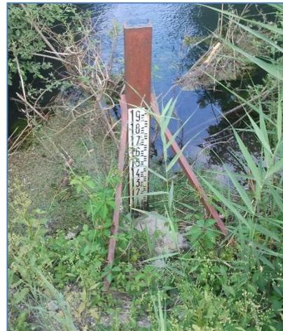
Photos 7 – Echelle limnimétrique L5 sur La Bialle en amont du site – Pont de la RD.32
