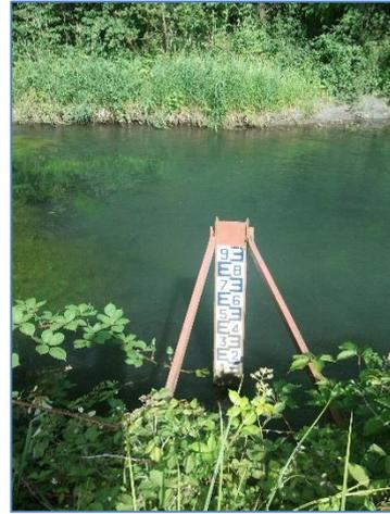
Photos 6 – Echelle limnométrique L4 sur La Bialle en aval du site
